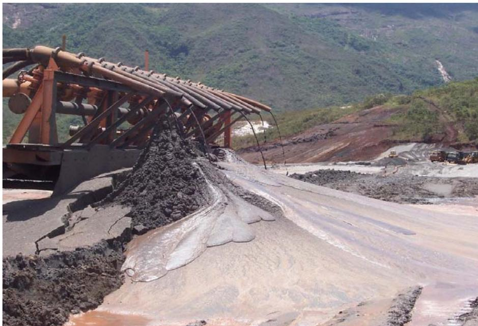
Figura 3.5 – Disposição de rejeitos pela técnica de ciclagem (hidrociclones)
