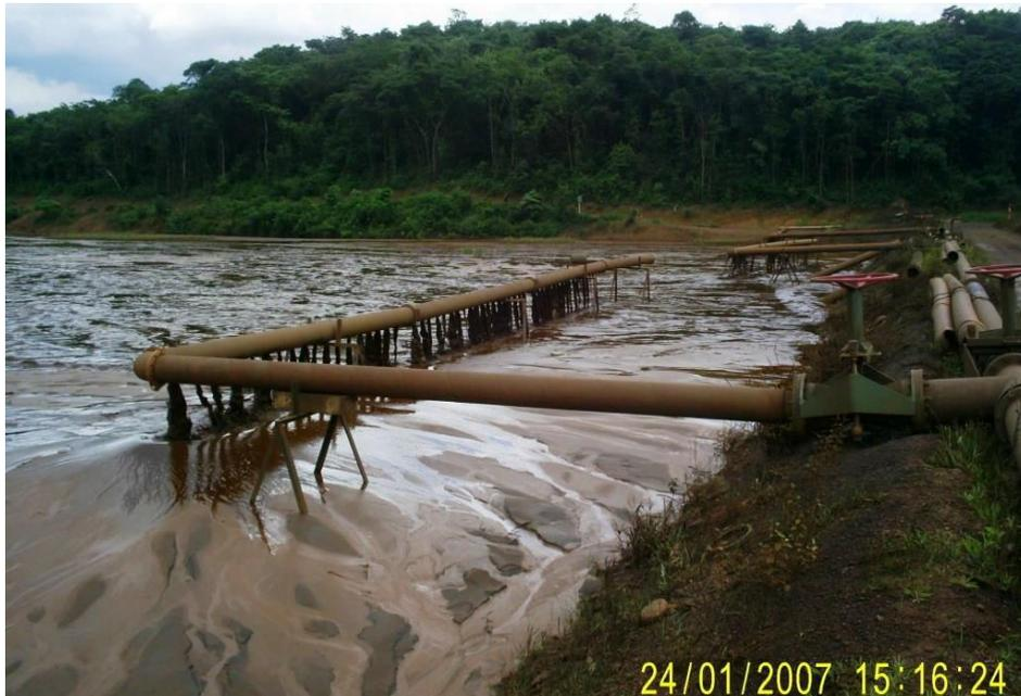
Figura 3.6 – Disposição de rejeitos pela técnica de *spray bars*
